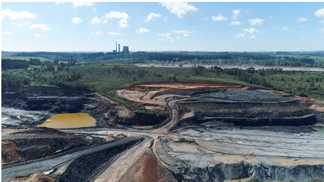
Imagem 3: Exploração pelo método de lavra em tiras na mina Candiotá, com a usina de Candiotá III ao fundo. Fonte: Acervo institucional do Instituto Internacional ARAYARA (2023), crédito Sara Ribeiro.
